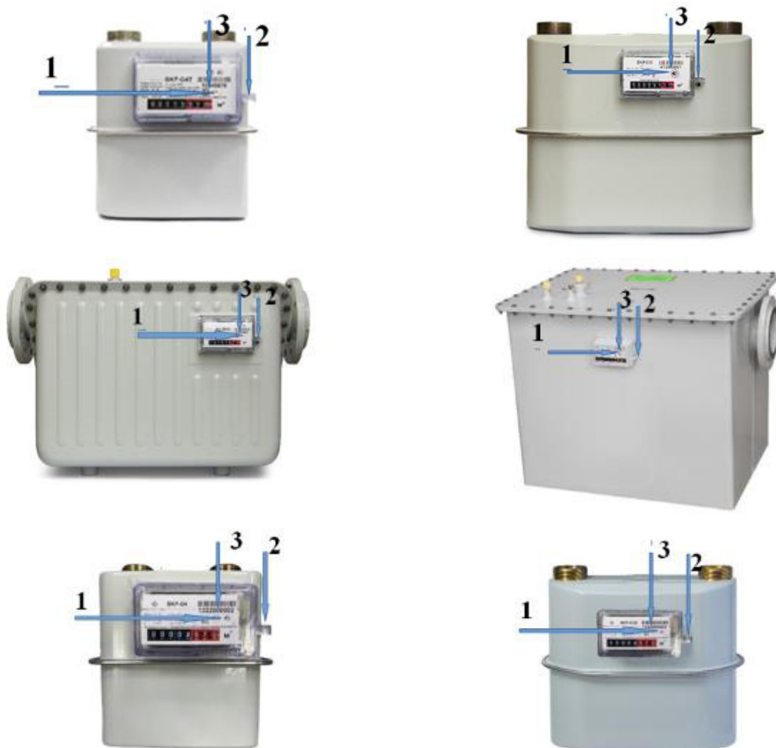
Рисунок 2 – Схема пломбировки от несанкционированного доступа, обозначения мест нанесения: 1 - знака утверждения типа, 2- знака поверки, 3-заводского номера
