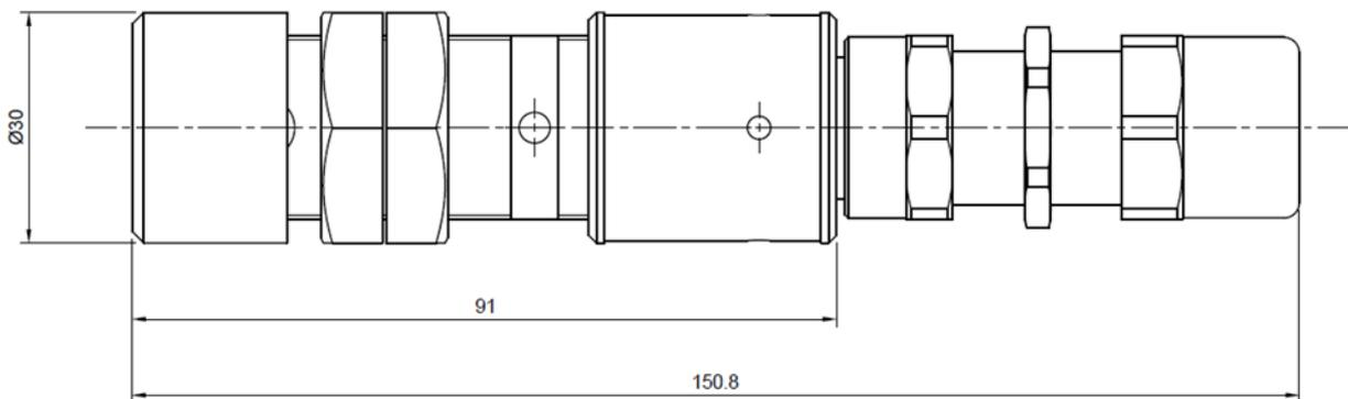
Рисунок А.48 – Внешний вид и габаритные размеры газоанализатора стационарного KAM200-97
