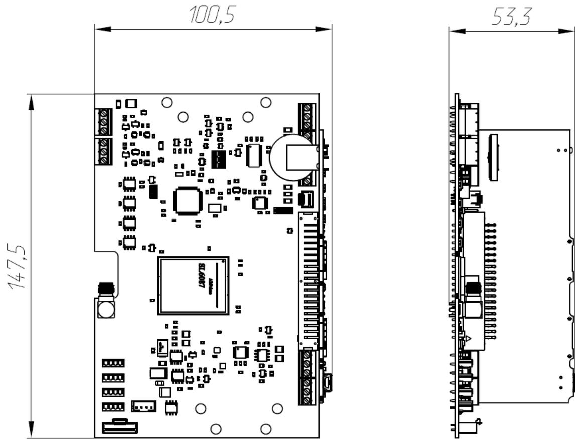
Рисунок А.9 – Внешний вид и габаритные размеры модуля процессорного KAM200-15BK
