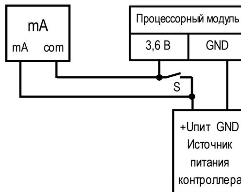
Рисунок 10 - Схема соединений источника питания, процессорного модуля KAM200 и мультиметра для измерения тока потребления в режиме "глубокий сон"
