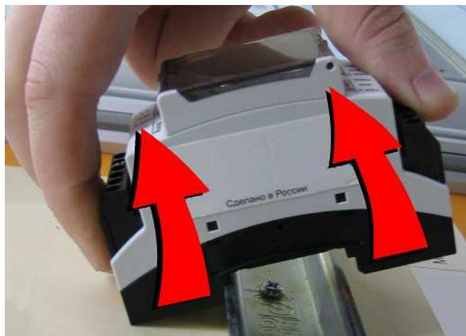
Рисунок 6 – Демонтаж модуля с DIN-рейки
