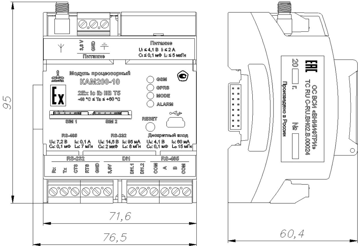
Рисунок А.1 – Внешний вид и габаритные размеры модуля процессорного КАМ200-10
