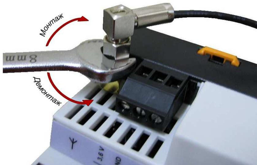
Рисунок 8 – Подключение антенно-фидерных устройств к модулю процессорному
