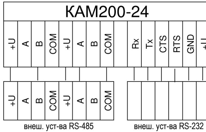
Рисунок Б.4 – Схема подключения внешних устройств к модулю KAM200-24
