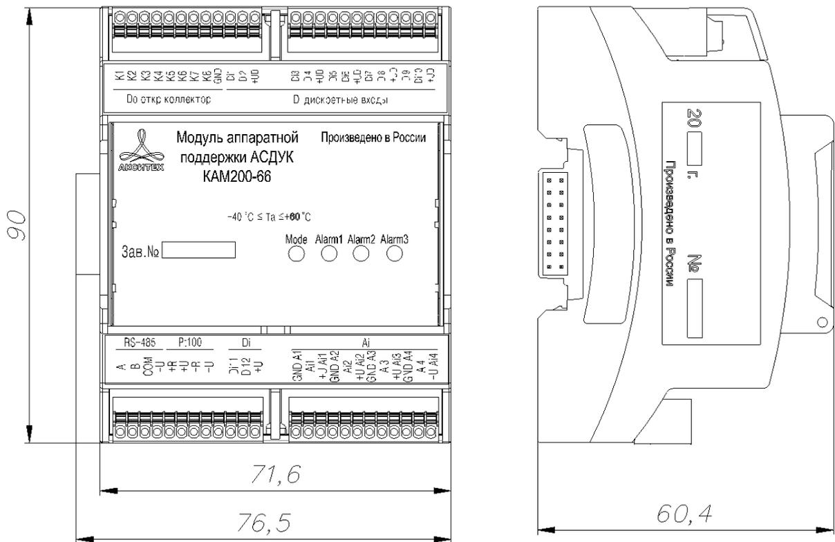
Рисунок А.23 – Внешний вид и габаритные размеры модуля аппаратной поддержки АСДУК KAM200-66
