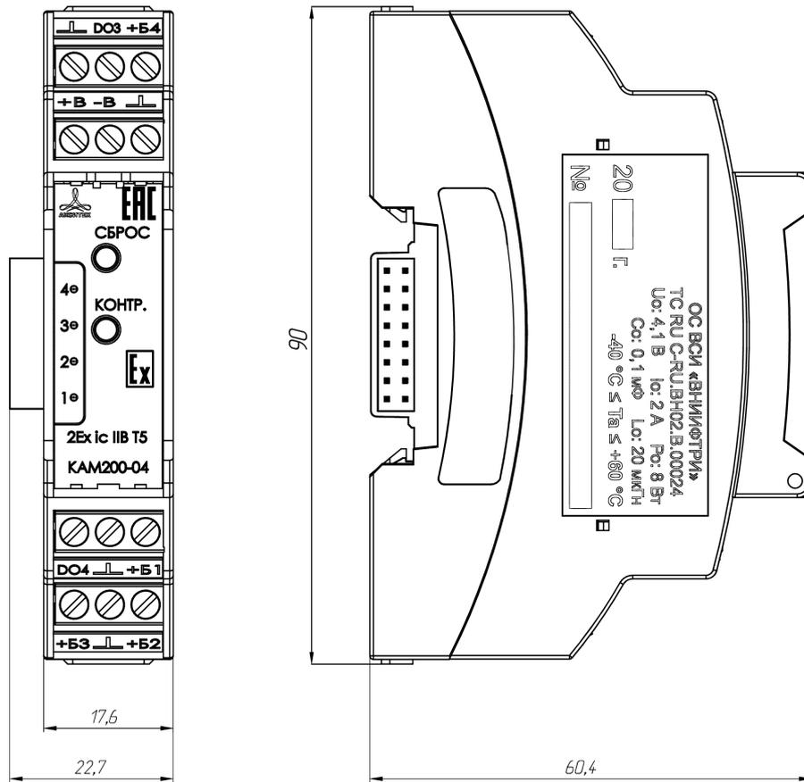
Рисунок А.33 – Внешний вид и габаритные размеры модуля коммутации батарей KAM200-04
