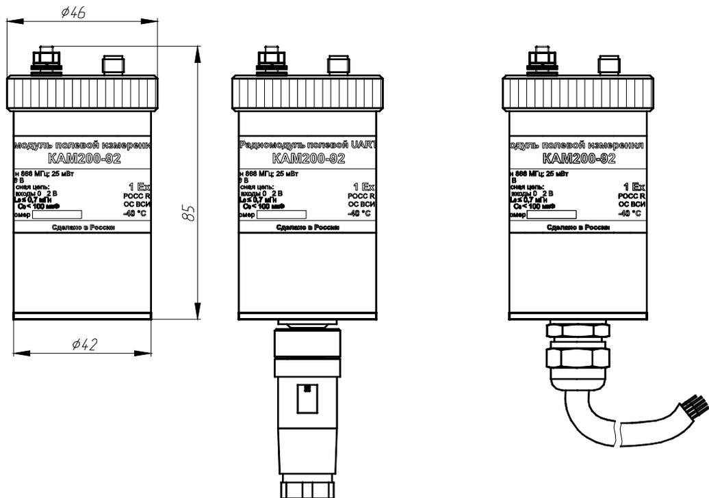
Рисунок А.36 – Внешний вид и габаритные размеры радиомодуля полевого измерения давления KAM200-92
