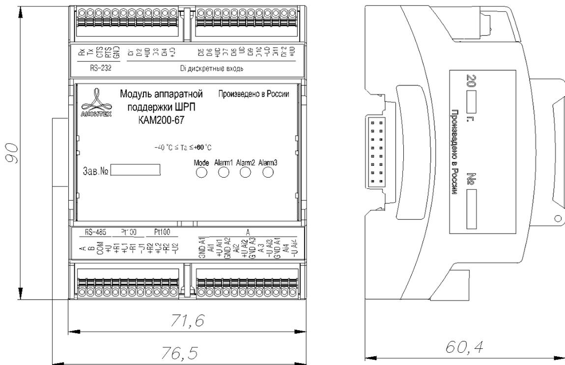
Рисунок А.24 – Внешний вид и габаритные размеры модуля аппаратной поддержки ШРП KAM200-67
