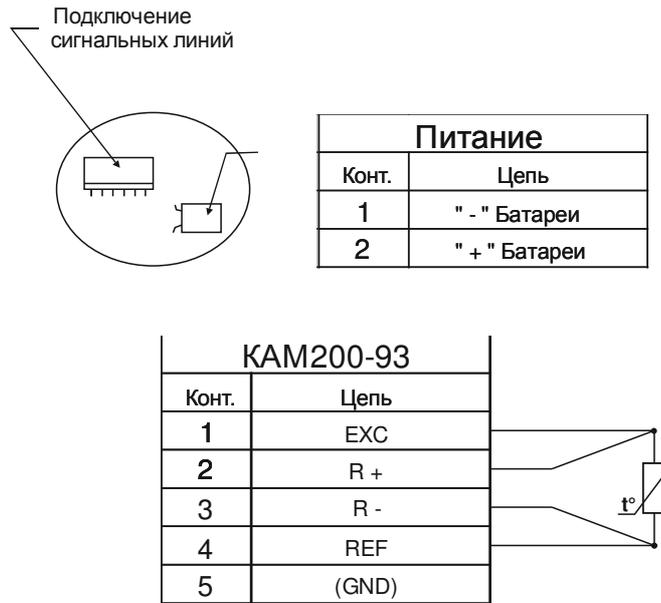
Рисунок Б.16 – Схема подключения внешних устройств к радиомодулю полевому измерению температуры KAM200-93
