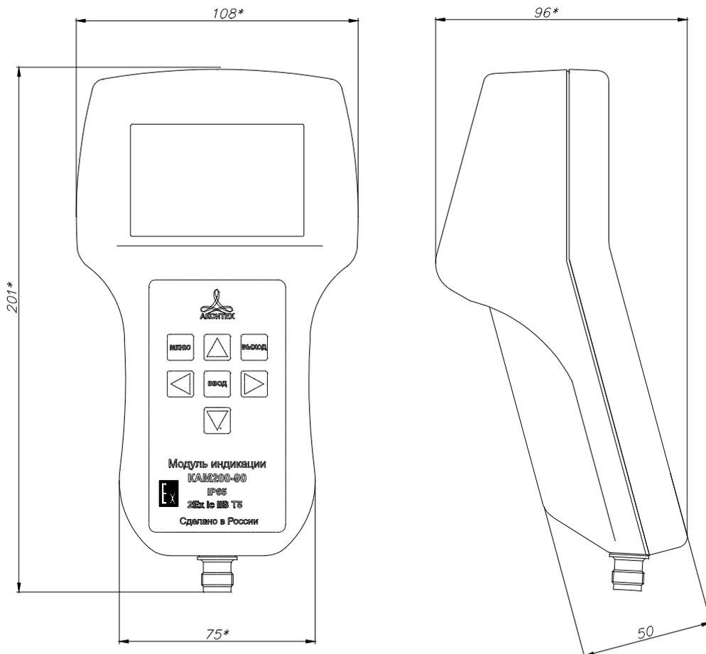
Рисунок А.34 – Внешний вид и габаритные размеры модуля индикации KAM200-90
