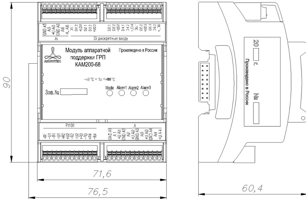
Рисунок А.25 – Внешний вид и габаритные размеры модуля аппаратной поддержки ГРП
