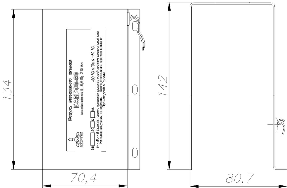
Рисунок А.45 – Внешний вид и габаритные размеры модуля автономного питания KAM200-00 исполнение 6
