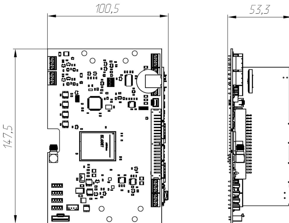
Рисунок А.8 – Внешний вид и габаритные размеры модуля процессорного KAM200-14BK
