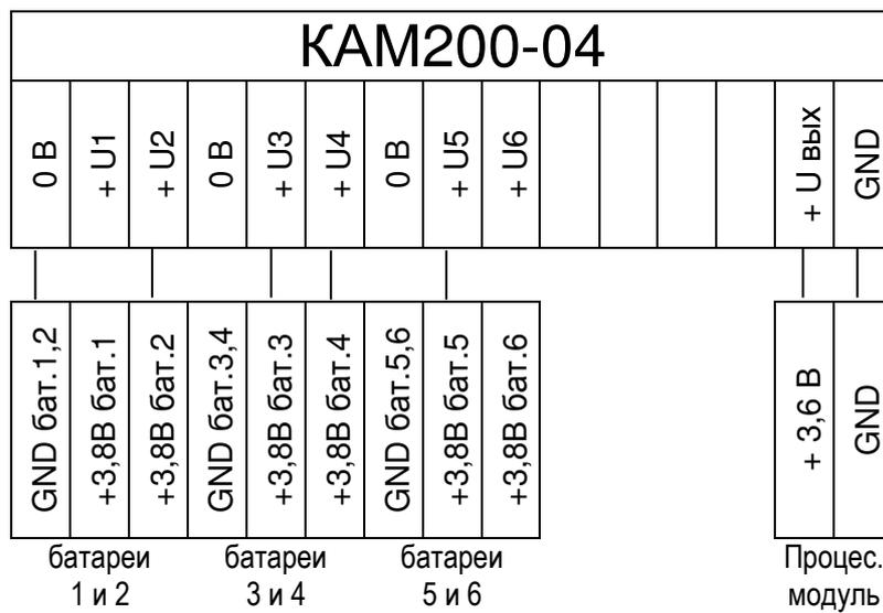
Рисунок Б.21 – Схема подключения внешних устройств к модулю KAM200-04
