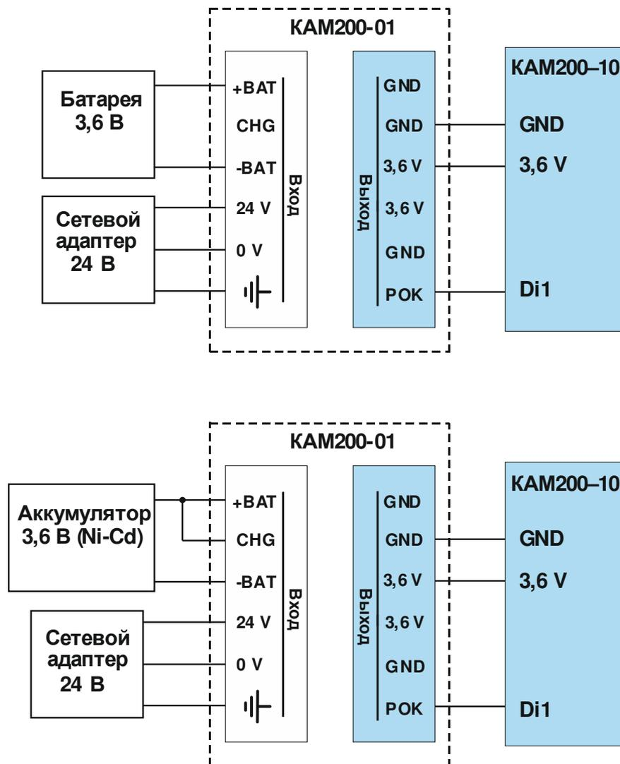
Рисунок Б.14 – Схемы подключения внешних устройств к модулю внешнего питания
