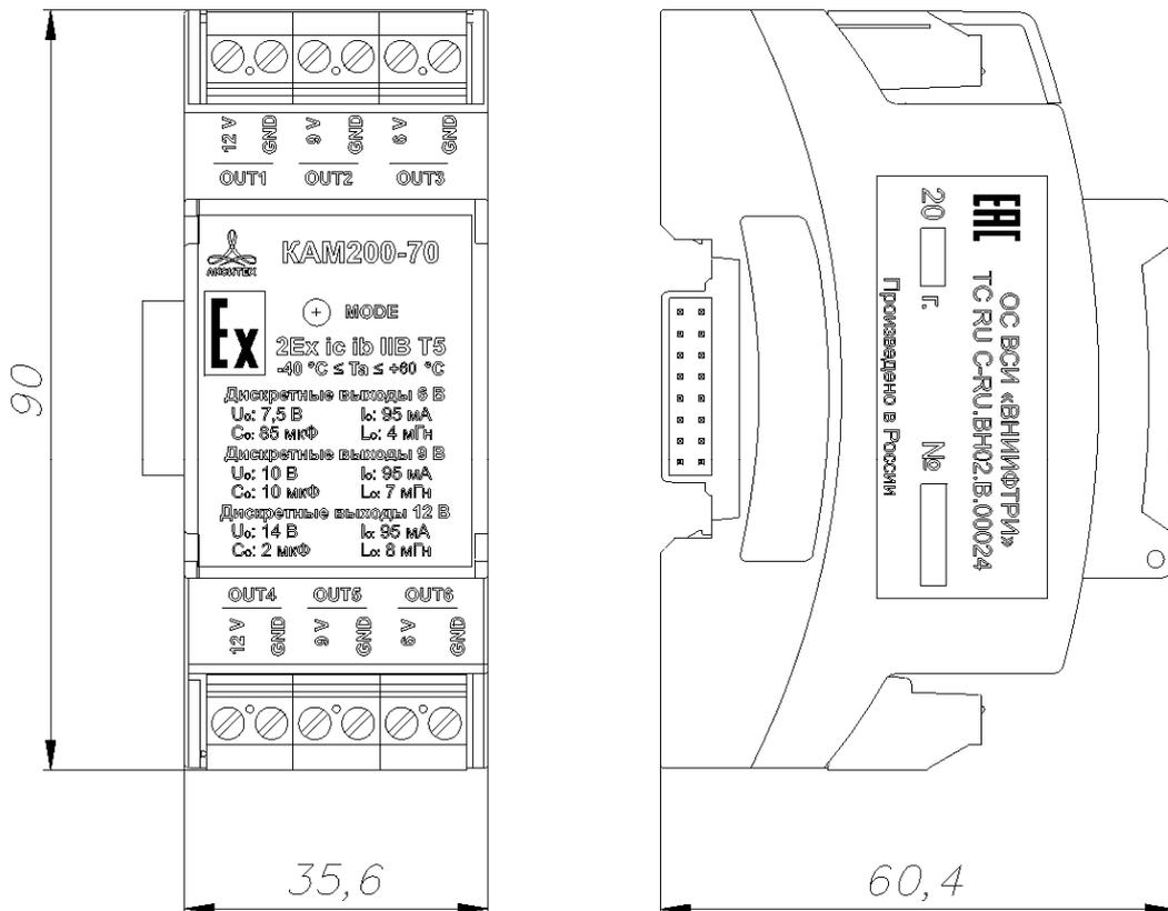
Рисунок А.26 – Внешний вид и габаритные размеры модуля дискретных выходов КАМ200-70
