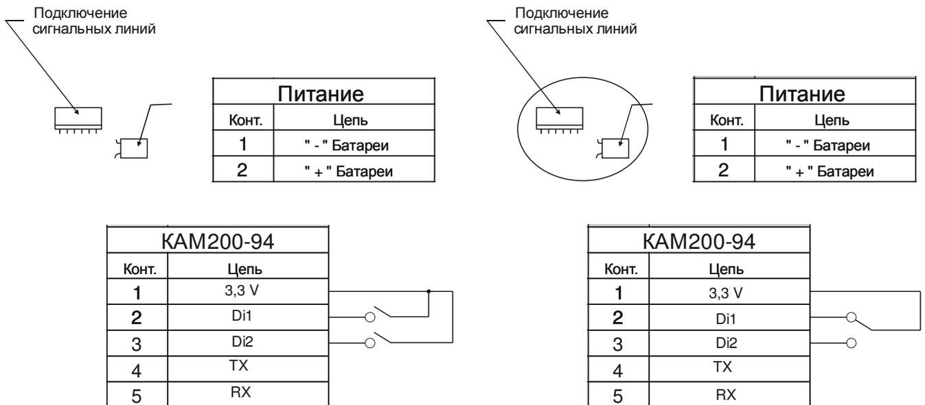
Рисунок Б.17 – Схема подключения внешних устройств к радиомодулю полевому дискретных входов KAM200-94
