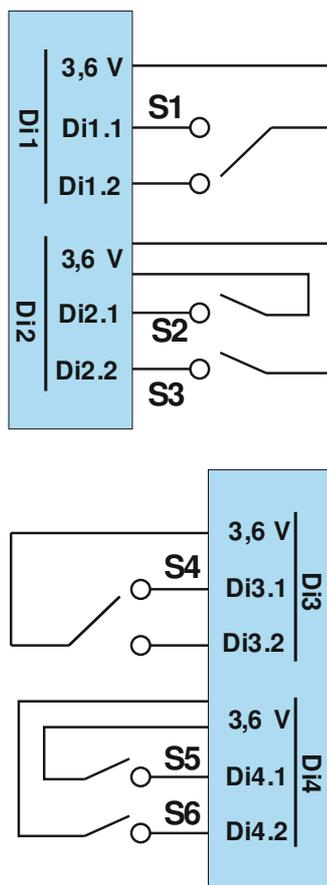
Di1...Di4 – дискретный вход для подключения датчиков типа «сухой контакт»;
