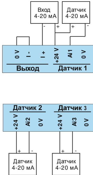
Рисунок Б.9 - Схема подключения модулей КАМ200-62 и КАМ200-63 с пассивными датчиками
