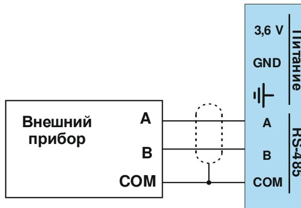
Рисунок Б.5 – Схема подключения внешних устройств по интерфейсу RS-485 к модулю связанному радиочастотному KAM200-20
