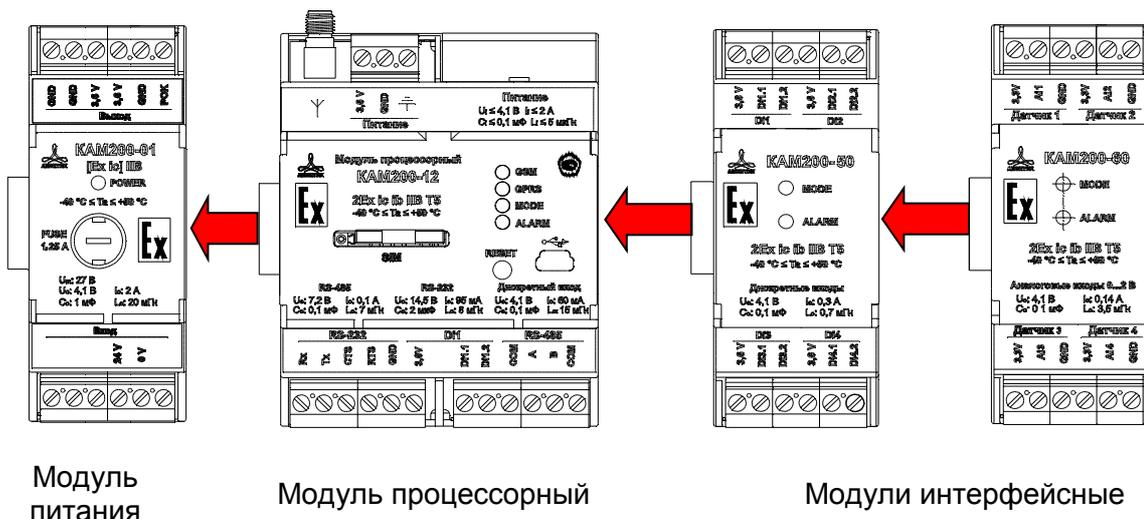
Рисунок 3 – Подключение модулей
