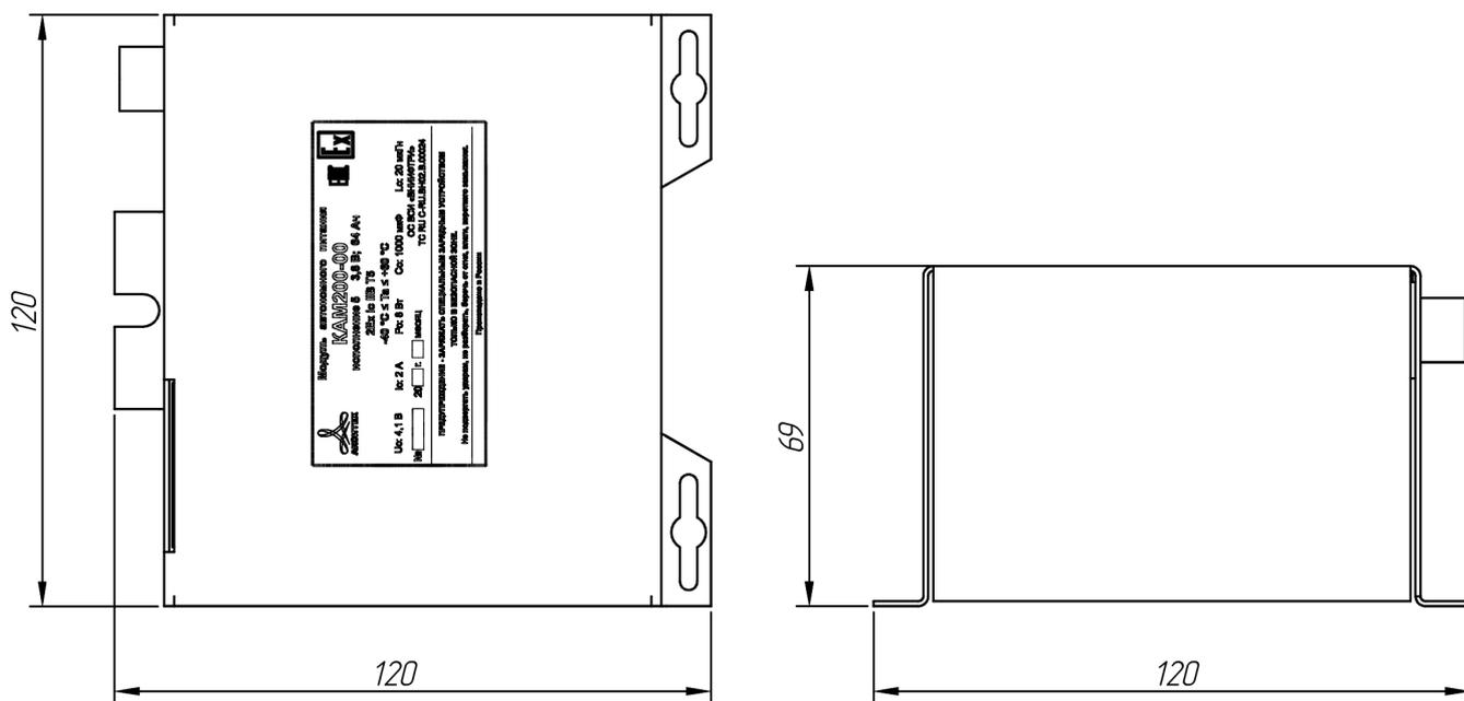
Рисунок А.44 – Внешний вид и габаритные размеры модуля автономного питания KAM200-00 исполнение 5
