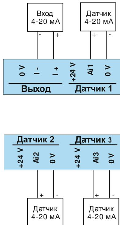
Схема подключения КАМ200-62 с активными датчиками и выходов КАМ200-72
