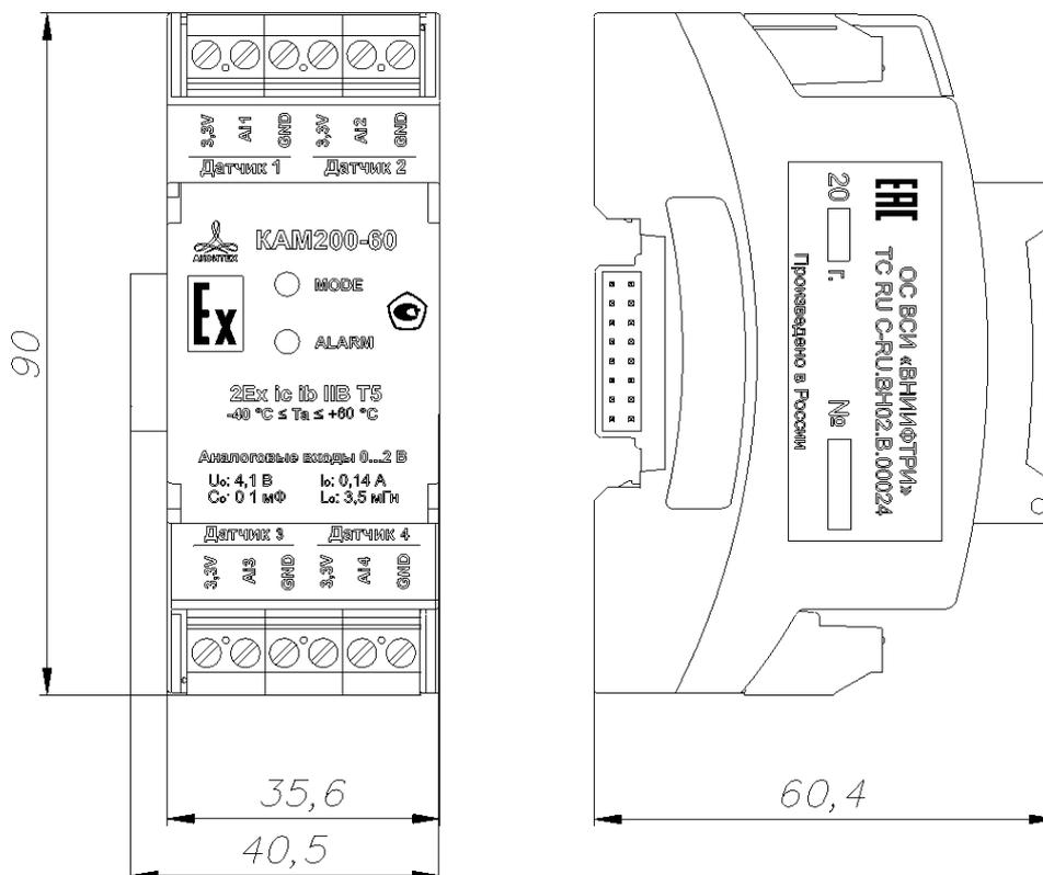
Рисунок А.18 – Внешний вид и габаритные размеры модуля измерения давления KAM200-60
