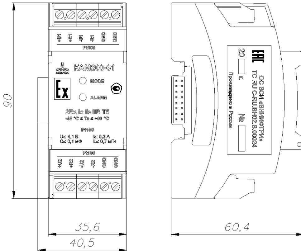
Рисунок А.19 – Внешний вид и габаритные размеры модуля измерения температуры KAM200-61
