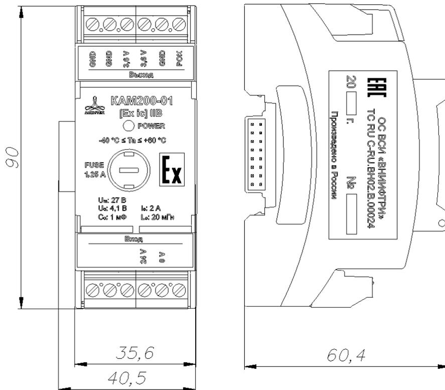
Рисунок А.30 – Внешний вид и габаритные размеры модуля внешнего питания KAM200-01
