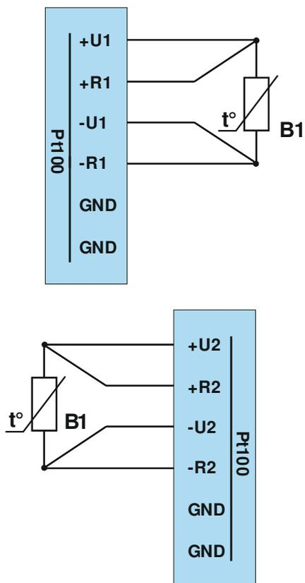
B1, B2 – термопреобразователь сопротивления типа Pt100.
