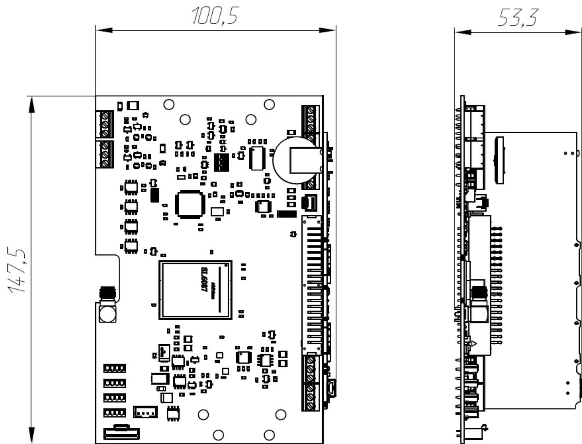
Рисунок А.3 – Внешний вид и габаритные размеры модуля процессорного KAM200-10BK
