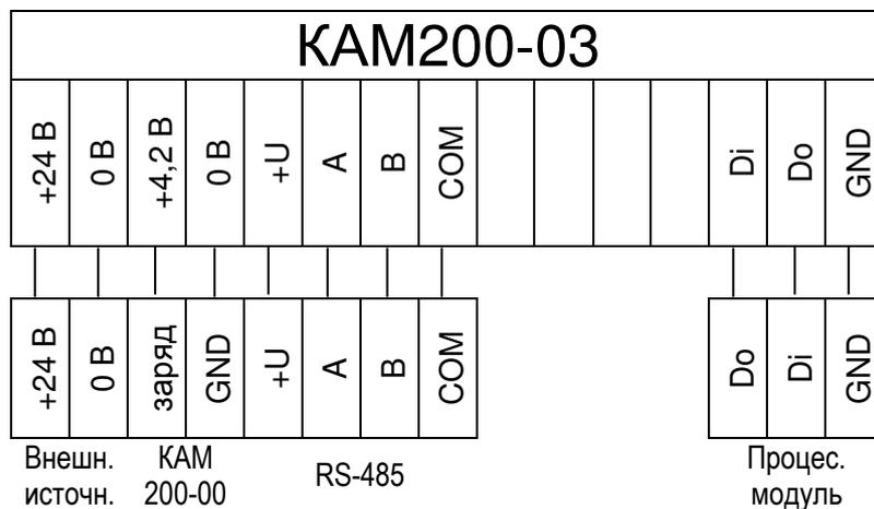
Рисунок Б.20 – Схема подключения внешних устройств к модулю KAM200-03
