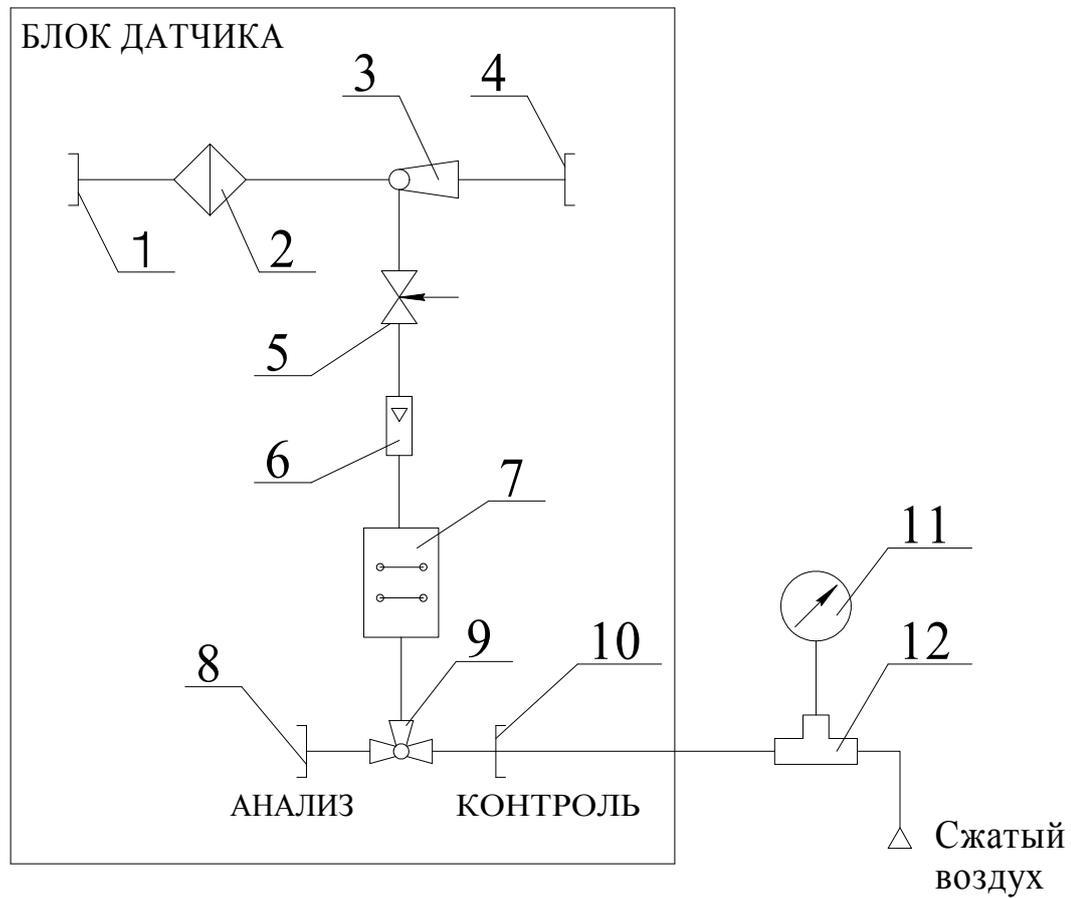
Рисунок 2.2 - Схема установки для проверки герметичности
