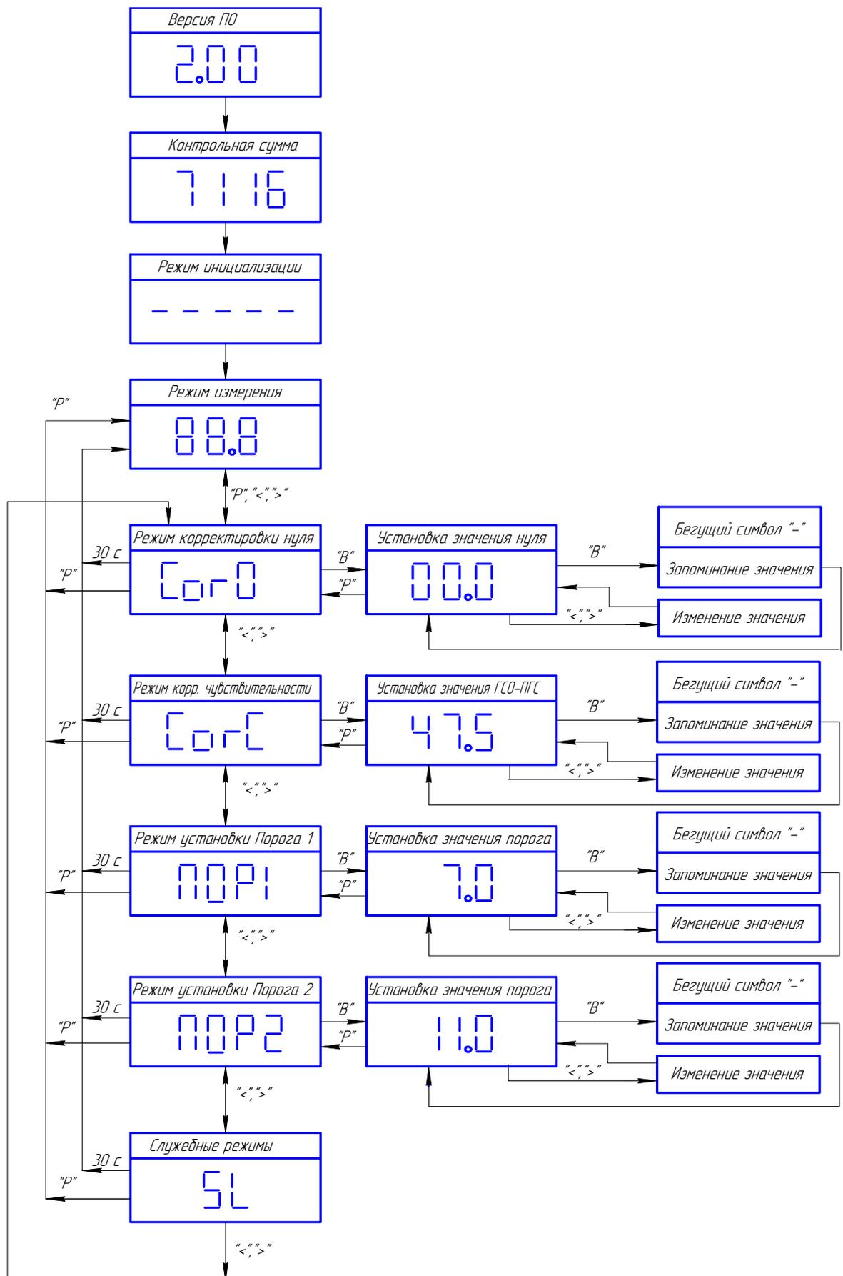
Рисунок Л.1 - Схема режимов работы газоанализаторов ДАХ-M-01
