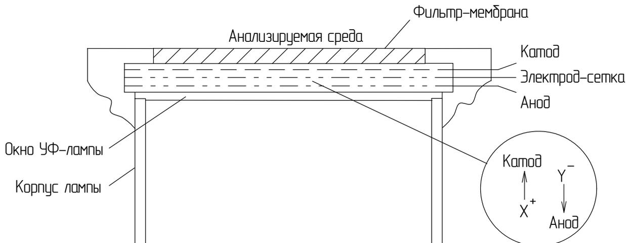
Рисунок 1.2 – Схема работы ФИД
