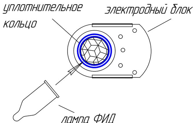
Рисунок 2.5 – Установка лампы ФИД в электродный блок
