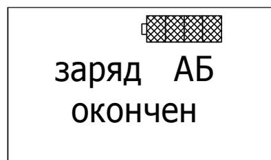
Рисунок 3.2 – Режим окончания заряда батареи аккумуляторной
