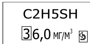
Рисунок 3.6 – Внешний вид меню корректировки чувствительности по C<sub>2</sub>H<sub>5</sub>SH
